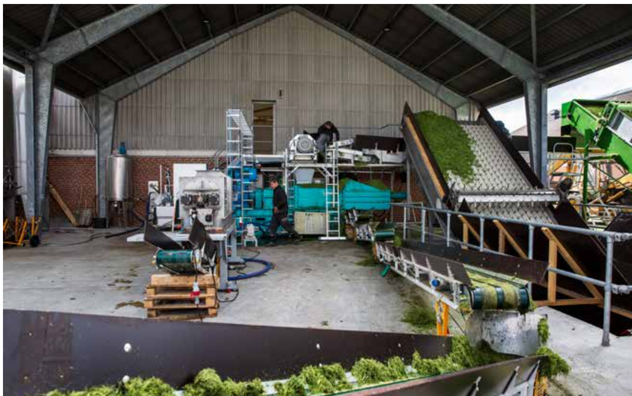
Bioraffinaderiet i Foulum er et eksempel på cirkulær grøn bioøkonomi – her omdannes græs til bæredygtig produktion af energi og foder af høj kvalitet. Foto: AU-Foto, Lars Kruse
